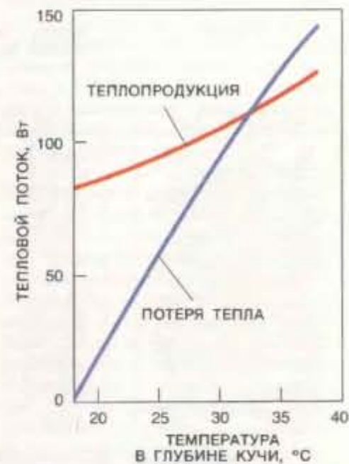
РАВНОВЕСНАЯ ТЕМПЕРАТУРА в куче соответствует точке пересечения кривых теплового потока, когда тепла образуется столько же, сколько рассеивается.
